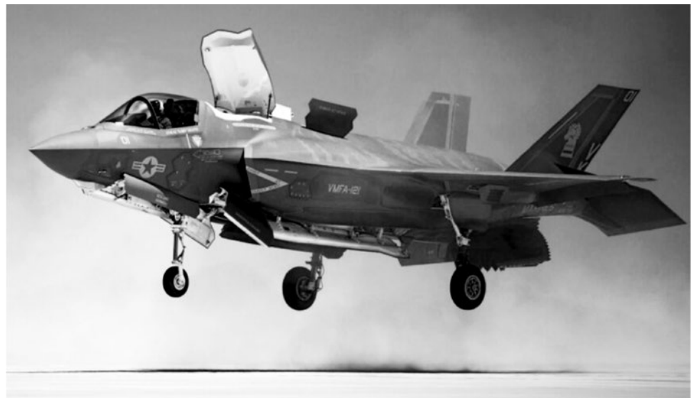
Senkrechtlandung einer F-35B. Für die neuen starken Triebwerke war die alte englische Technologie des britischen Harrier nicht mehr tauglich. Archiv Jeschke
