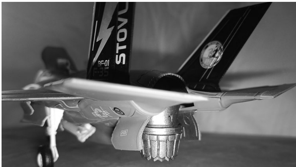
Gut zu sehen der Schwenkmechanismus der Schubdüse der F-35. Diese Technologie wurde von sowjetischen Ingenieuren für die Jak-141 entwickelt. (Modellaufnahme) Archiv Jeschke
